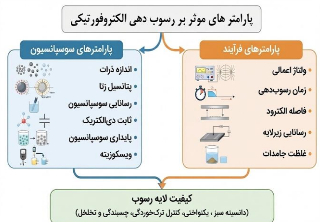
شکل ۳. نمای کلی پارامترهای موثر بر رسوب دهی الکتروفوریتیکی
