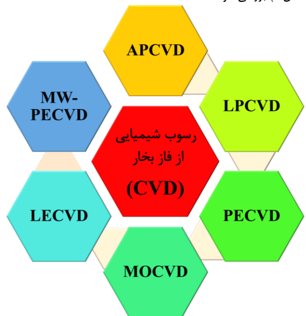
شکل ۵- انواع مختلف روش های رسوب دهی شیمیایی از فاز بخار
