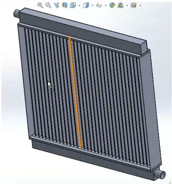
شکل ۴- مدلسازی مخازن بالا و پایین در این رادیاتور
