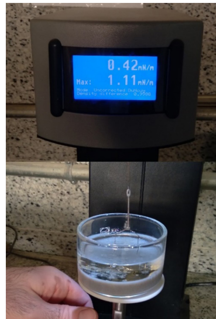
شکل ۱۸: مقدار کشش بین سطحی اندازه گیری شده در سطح مشترک بین غلظت ۲۵۰۰ پی پی ام نانوسیال GO-SiO 2 -TiO 2 و نفت سفید
