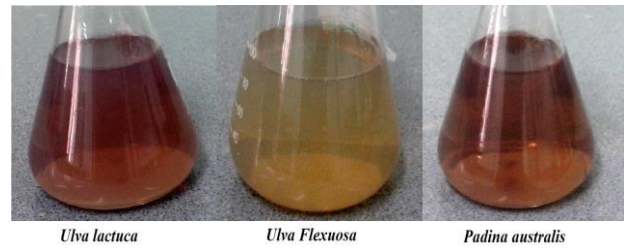
شکل ۱: تغییرات رنگ عصاره جلبک‌ها: (الف) مرحله ابتدایی افزودن نیترات نقره، (ب) گذشت ۲۴ ساعت پس از افزودن نیترات نقره به عصاره‌های جلبک‌ها
