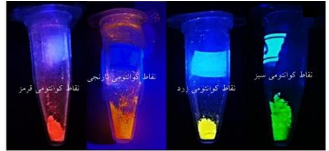
شکل ۱: تصویر پودر نقاط کوانتومی تهیه شده در pH های مختلف (از راست به چپ ۸٫۴، ۹٫۲، ۱۰٫۶، و ۱۱٫۴)، تحت تابش نور فرابنفش ۳۶۵ نانومتری.
