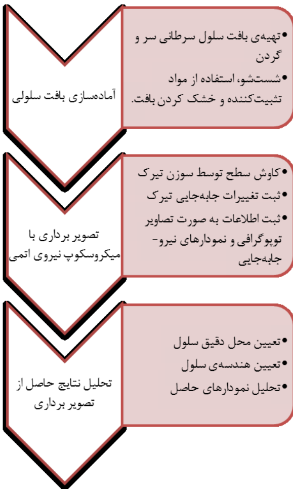
شکل ۱: فرایند نانومنیپولیشن بافت سرطانی سر و گردن
