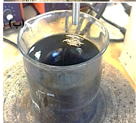
شکل ۱: (الف) سنتز پودر GO، (ب) نانو سیال آب-اکسید گرافن پس از فرایند اولتراسونیک.
