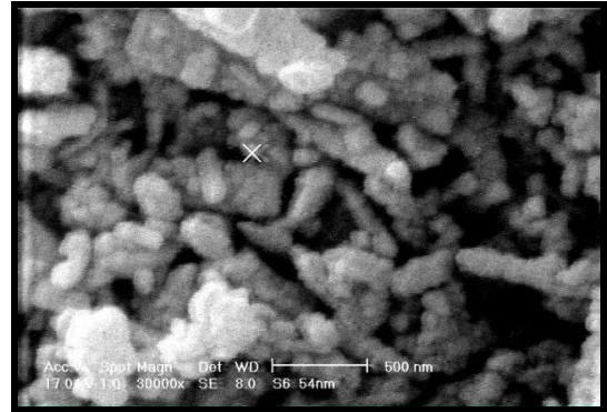
شکل ۱۲: SEM پودر حاوی اکسید مس (۵۴ nm) در محیط تارتارات سدیم ۱٪.
