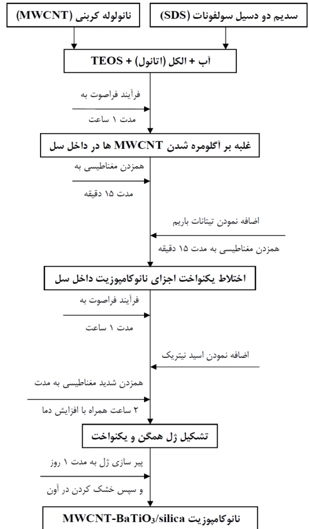
شکل ۱: نمودار گردشی از مراحل مختلف تهیه نانوکامپوزیت.
