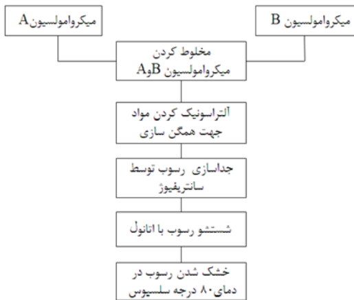
شکل ۱ مسیر انجام سنتز نانو پودرهای گارنت ایتريوم آهن به روش میکروامولسیون
