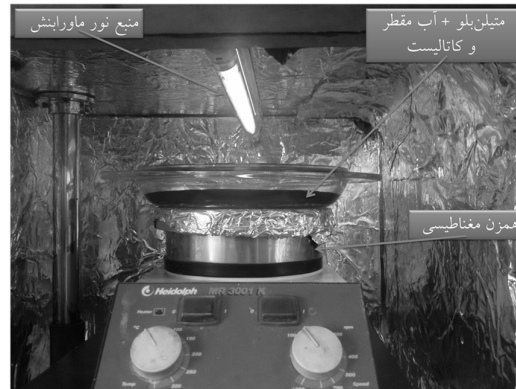
شکل ۱: تصویر فوتوراکتور استفاده شده برای تخریب متیلن‌بلو در حضور کاتالیزت SrFe 12 O 19
