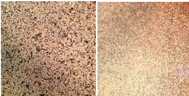
شکل ۱: تصویر میکروسکوپی نمونه‌ها با لایه نشانی در: (الف) دمای ثابت (ب) دمای متغیر
