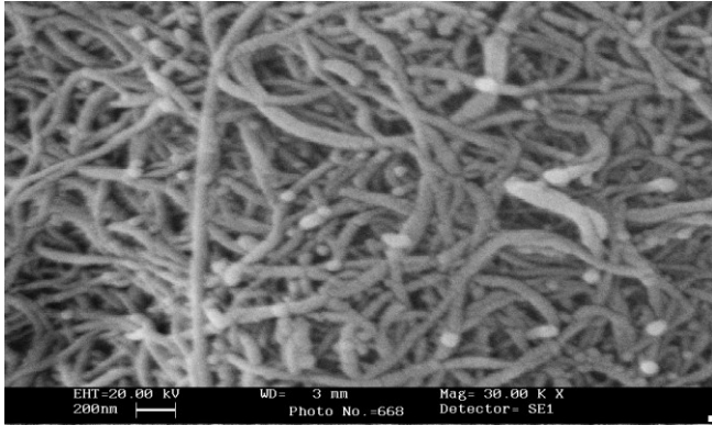
شکل ۲-۱- تصاویر میکروسکوپ الکترونی از نانولوله های کربنی عامل دار شده با بزرگنمایی ۳۰ هزار برابر.
