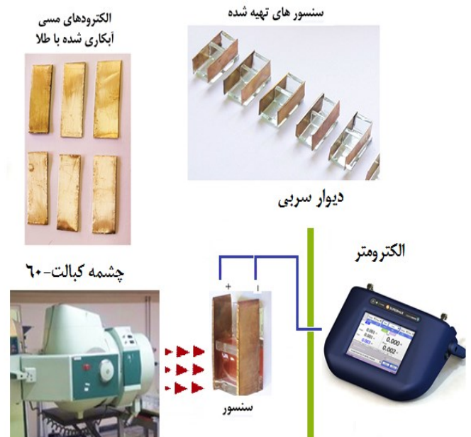
شکل ۲: تصاویر الکترودهای مسی آبکاری شده با طلا و حسگرهای تهیه شده (بالا) و چیدمان اندازه گیری جریان های الکتریکی (پایین)
