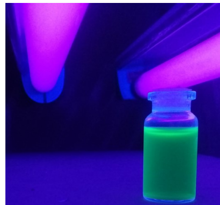
شکل ۴: تصویر محلول نقاط کوانتومی آلاینده به گادولینیم تحت نور لامپ ماوری بنفش پس از ۵ ساعت حرارت دهی در دمای 100^{\circ}\text{C} .
