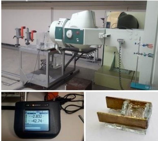
شکل ۳. ماشین Picker V9 60 Co حاوی چشمه ی پرتو گاما و نانوحسگر که با سیم درمقابل آن قرار گرفته است (بالا) و الکترومتر وحسگر آماده شده (پایین).
