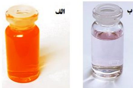
شکل ۱. تصویر نقاط کوانتومی CdTe سنتز شده (الف)، تصویر نانوذرات طلای سنتز شده (ب)
